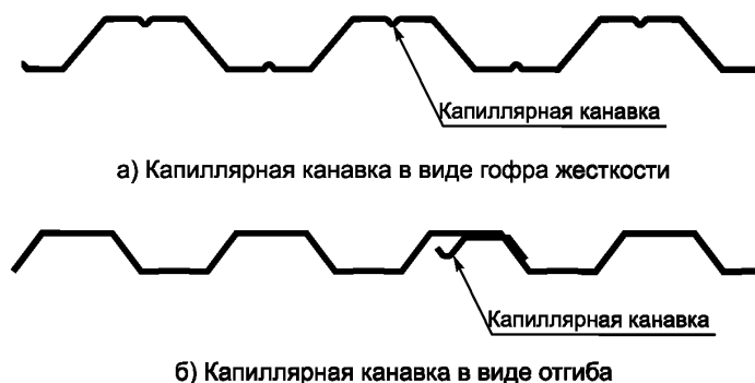
Рисунок 3 — Основные виды капиллярных канавок
